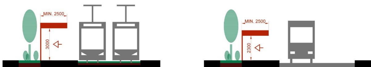
Obr. 16: Schéma so svetlou výškou prístrešku: električka, autobus
